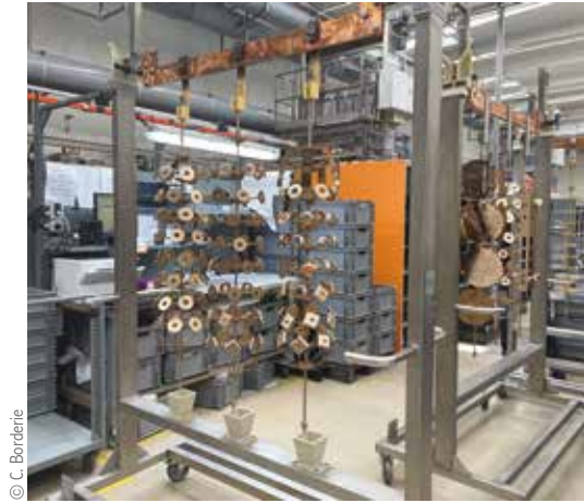
Le 2 e bâtiment de l'usine de Gessi comprend la partie consacrée à la finition, avec 9 machines dédiées à la pose de PVD.
